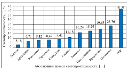
Рисунок 6 – Влияние растительных масел на светопропускание древесины
