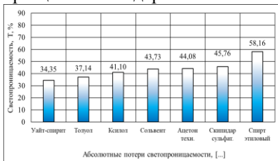
Рисунок 2 – Влияние органических растворителей на светопропускание древесины
